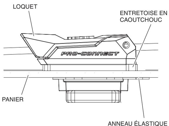
3. Soulevez le levier de chaque loquet jusqu'à ce qu'il se déverrouille. Placez le panier utilitaire sur le porte-bagages avant du VTT. Alignez chaque loquet avec chaque orifice correspondant dans le porte-bagages, puis insérez chaque loquet dans son orifice.
